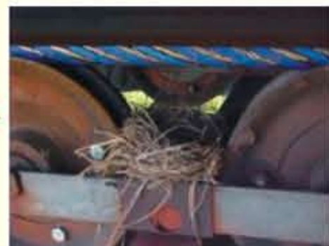
Ninho de pássaro entre as polias de uma correia em funcionamento
